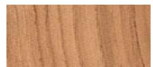
Per la sua durata e compattezza è usato per la produzione di pali (tutti i pali delle linee telefoniche sono di legno di castagno), mobili ed infissi, inoltre per la sua elasticità è utilizzato per realizzare travi.
